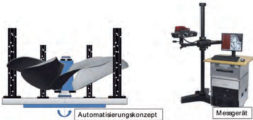
Abbildung 6: Messaufbau und -system für die Propellerprüfung
